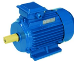
**Основное (базовое) исполнение** – электродвигатель, предназначенный для режима работы S1, от сети переменного тока 50 Гц напряжением 380В (220В, 660В). Климатическое исполнение и категория размещения У3, степень защиты IP54 с типовыми техническими характеристиками, соответствующими требованиям стандартов.
